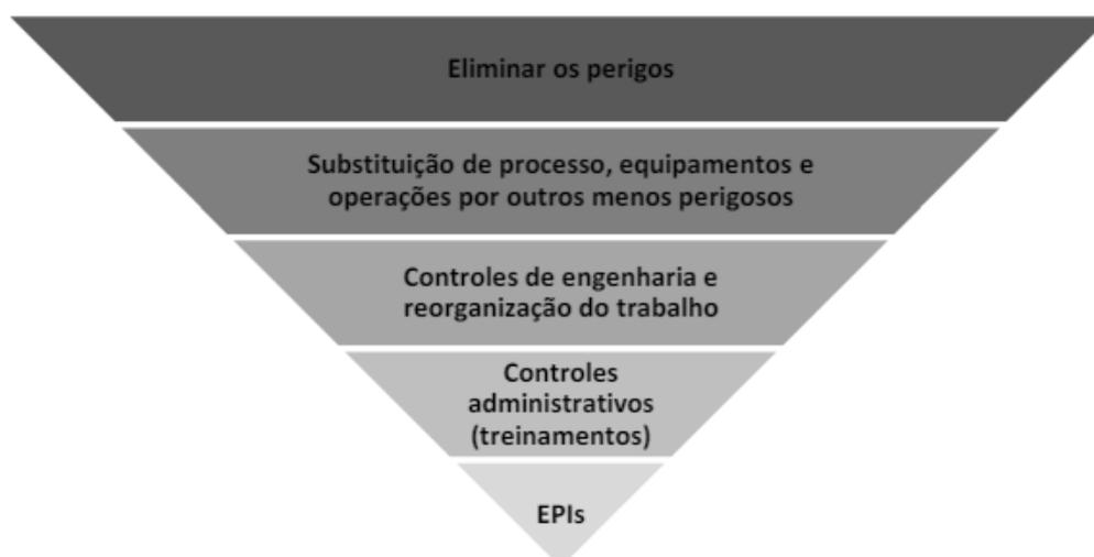
**FIGURA 16 - HIERARQUIA DO PROCESSO DE ELIMINAÇÃO DE PERIGOS E REDUÇÃO DE RISCOS.**
