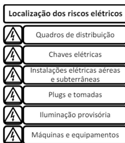
**FIGURA 15 - LOCALIZAÇÃO DE RISCO ELÉTRICO EM INSTALAÇÕES TEMPORÁRIAS.**
