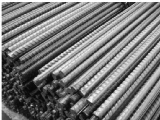
A diferença entre esses dois tipos se dá durante a sua aplicação, no qual o de superfície nervurada é utilizado nas obras da construção civil, devido a sua aderência junto ao concreto, enquanto o de superfície lisa é voltado para as indústrias de pré-moldados.
