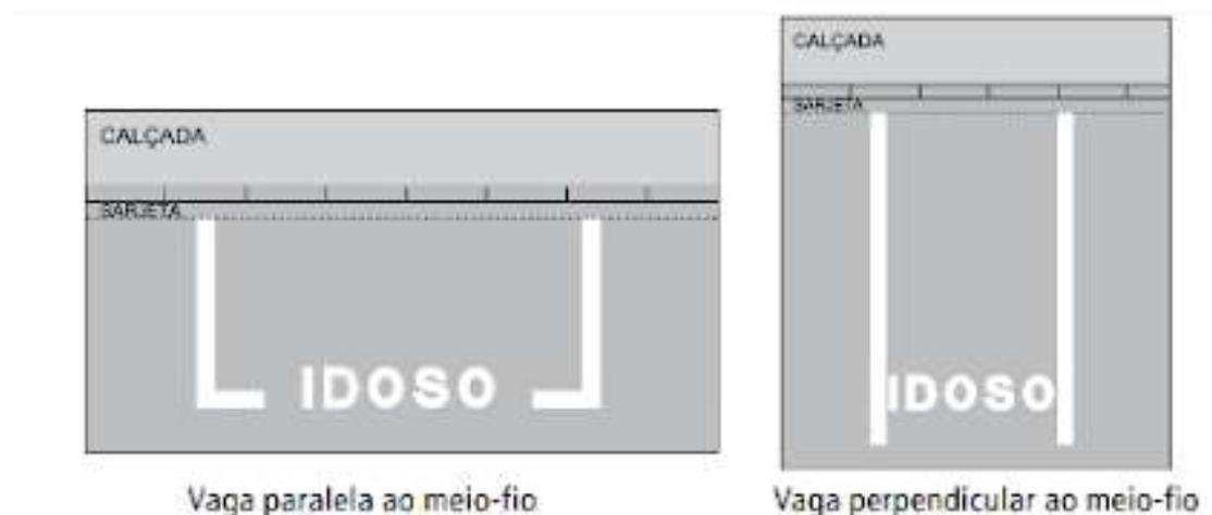
Fig. 05 – Sinalização horizontal de regulamentação de vaga de estacionamento exclusiva para idoso. Fonte: CONTRAN (2018)
