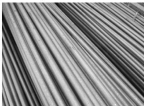
**Figura 2 -Vergalhão de superfície nervurada**
