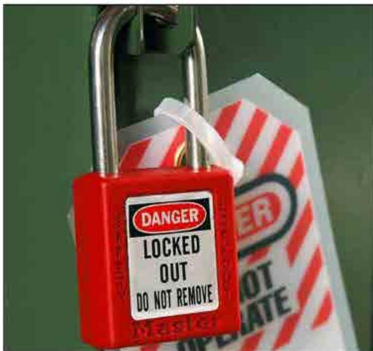
**FIGURA 20 - LOCKOUT-TAGOUT: MÉTODO DE BLOQUEIO.**
