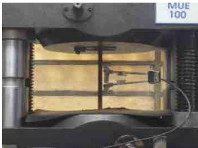
**Figura 11: Resistência à tração com barras de fibra de vidro.**
