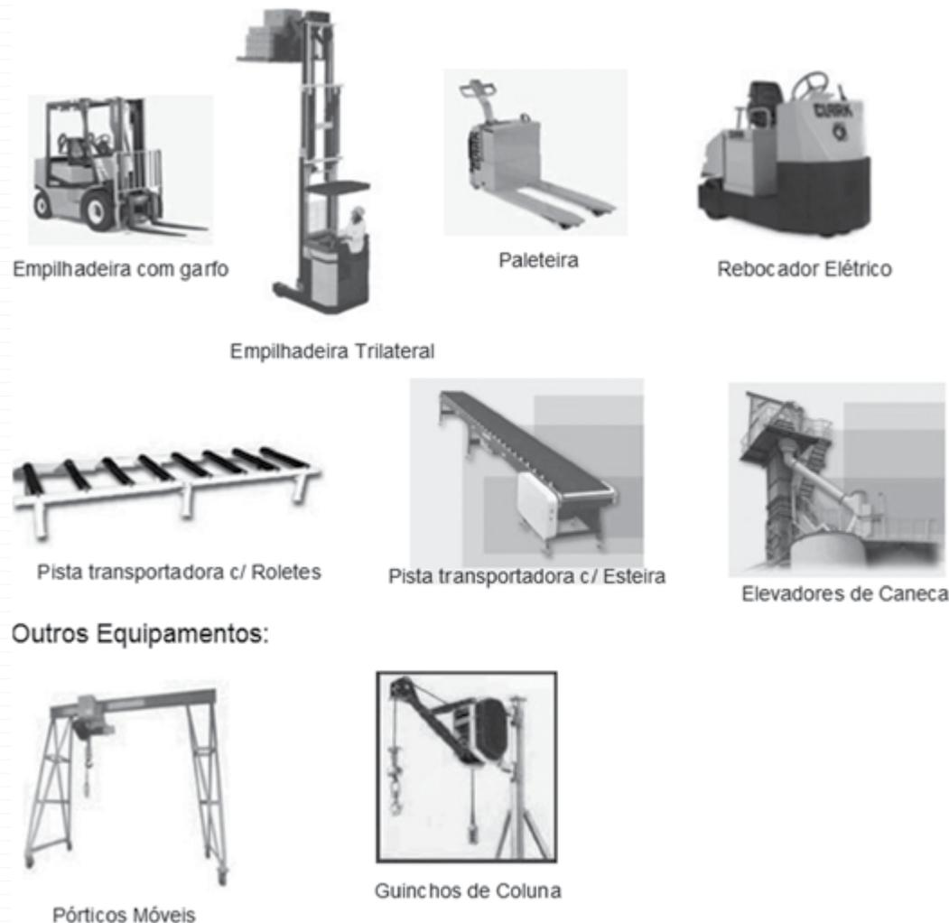
Figura 05 – Equipamento para manuseio nos Armazéns
