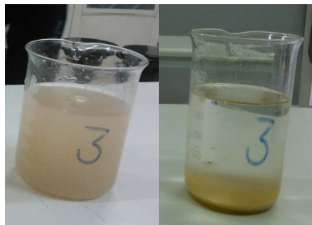
Figura 1: Água turva antes e depois do tratamento com semente de moringa.
