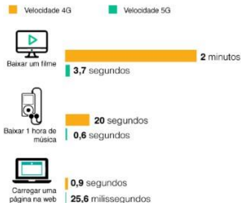
Figura 2 – Comparativo de velocidade de download entre a tecnologia 4G e a 5G
