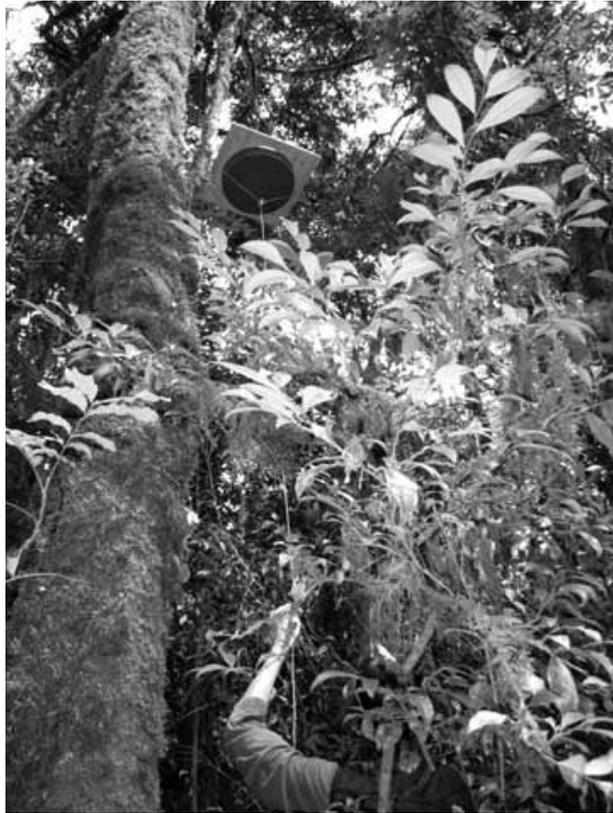
**Figura 3.** Armadilha suspensa colorida instalada no fragmento de Floresta Ombrófila Mista em processo de descida. Destaca-se a operação da corda guia.
