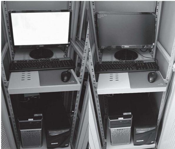
Figura 4: Servidor Windows Server 2008 (à esquerda) e Servidor Linux Debian (à direita) acomodados no rack e com nobreak.
